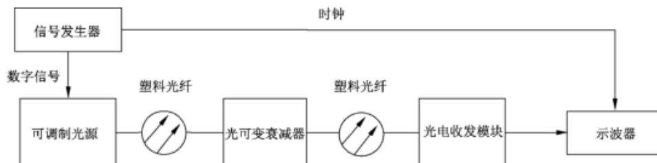
图 5 上升/下降时间、脉冲宽度失真测试配置示意图
