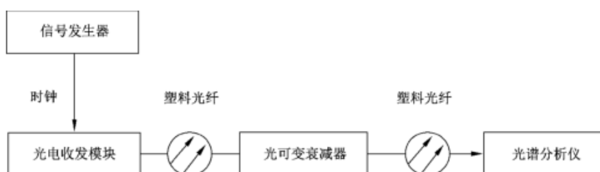
图 2 中心波长测试配置示意图
